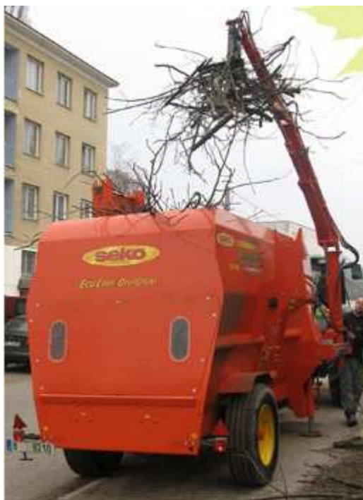
Obr. 1 Rezací a miešací voz s hydraulickou rukou, pripojený za traktorom
